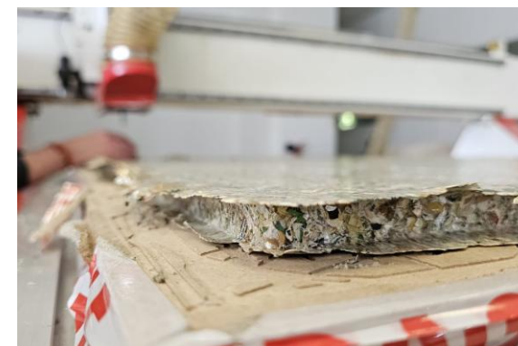
5. Découpe à la forme souhaitée des panneaux via fraiseuse industrielle
