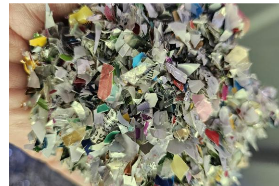
4. Broyage des sacs collectés et compactage dans nos ateliers (filère label ADEME)
